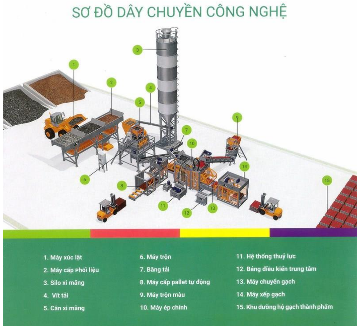
Hình 4: Sơ đồ dây chuyền công nghệ sản xuất gạch xi măng cốt liệu
