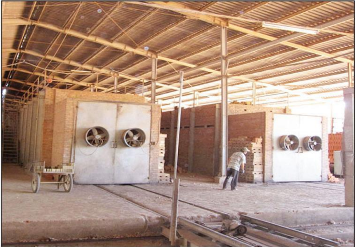
Hình 1: Công nghệ lò nung tuynel (lò hầm)
